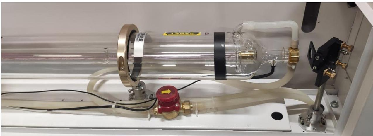
Не прилагая больших усилий, закрепите лазерную трубку в креплениях и подключите трубку к шлангам для подачи воды. Шланг для подачи воды подключите к левой части лазерной трубки, а шланг для отвода воды - к правой части. Шланг для отвода воды должен быть расположен вверху, чтобы отводить лишний воздух из лазерной трубки, иначе вода будет не полностью заполнять лазерную трубку, что приведет к её перегреву и преждевременному выходу из строя.
